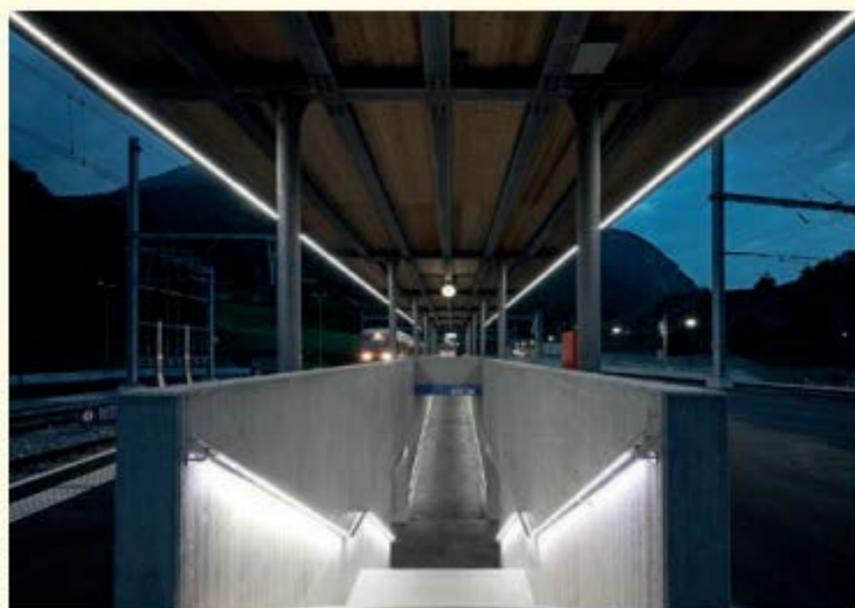
Handlauf LaneLED INOX42 und Lichtleiste LaneLED WALL
