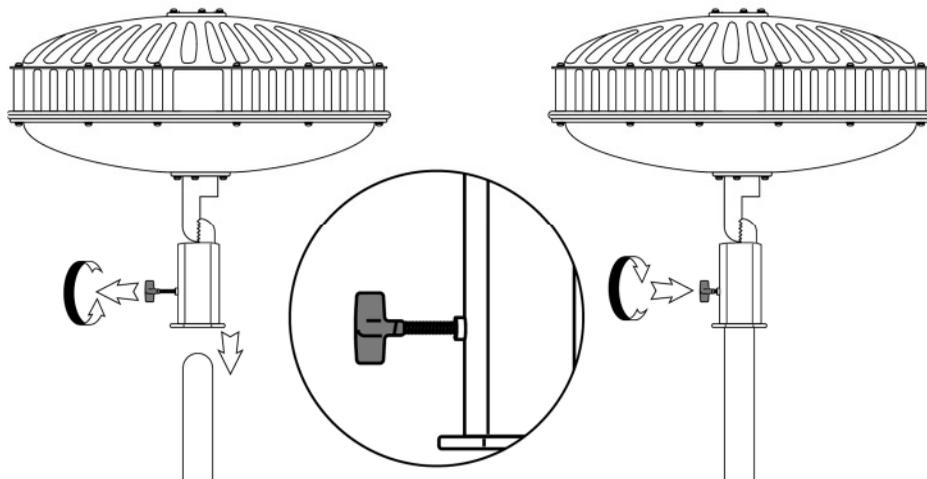
Neigungsverstellung / tilt adjustment  $\pm 0-45^\circ$
