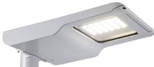
GIFAS StreetLED - mit asymmetrischer Lichtcharakteristik. Die Leuchte mit schlanker Bauform, hat ein Gehäuse aus Aluminiumdruckguss welches mit einer beständigen Epoxidfarbe pulverbeschichtet ist. Sie verfügt über ozon- sowie UV-beständige Dichtungen und Schrauben aus Edelstahl.
