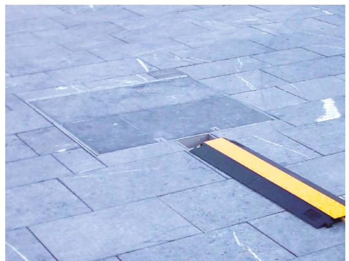
Massive Edelstahlkonstruktion 720 x 720 mm, bis C 250kN, belastbar, Gasdruckfedern zum leichteren Öffnen, Schachtdeckel individuell befüllbar (Wannentiefe 50 mm), Verteiler nach Kundenwunsch.
