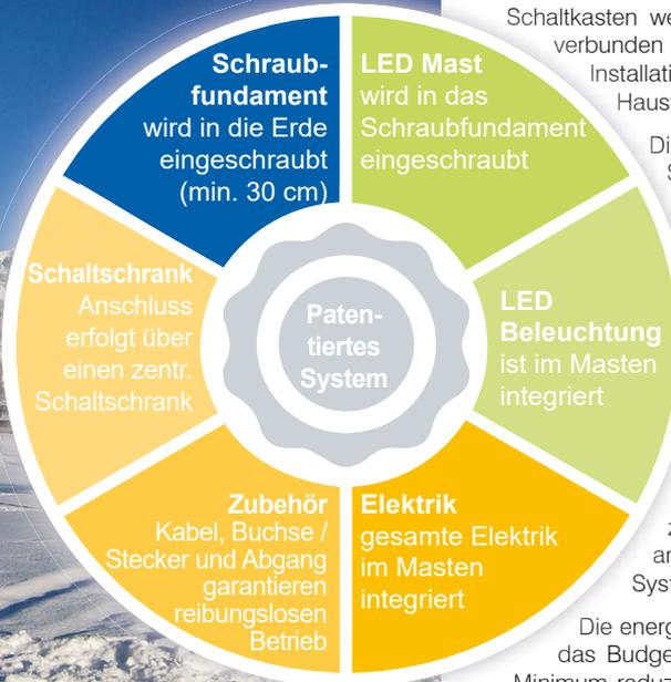
Das Beleuchtungsprinzip im Modulsystem ist simpel aber dennoch perfekt konstruiert und durchdacht. Die Beleuchtungsmasten werden mittels Schraubfundament im Erdreich verankert. Ausgehend von einem Schaltkasten werden die Masten im Anschluss mit Stromleitungen verbunden und schon steht das System zur Verfügung. Für die Installation benötigt man keine teuren Fachkräfte, lediglich Hausverstand und ein wenig handwerkliches Geschick.
