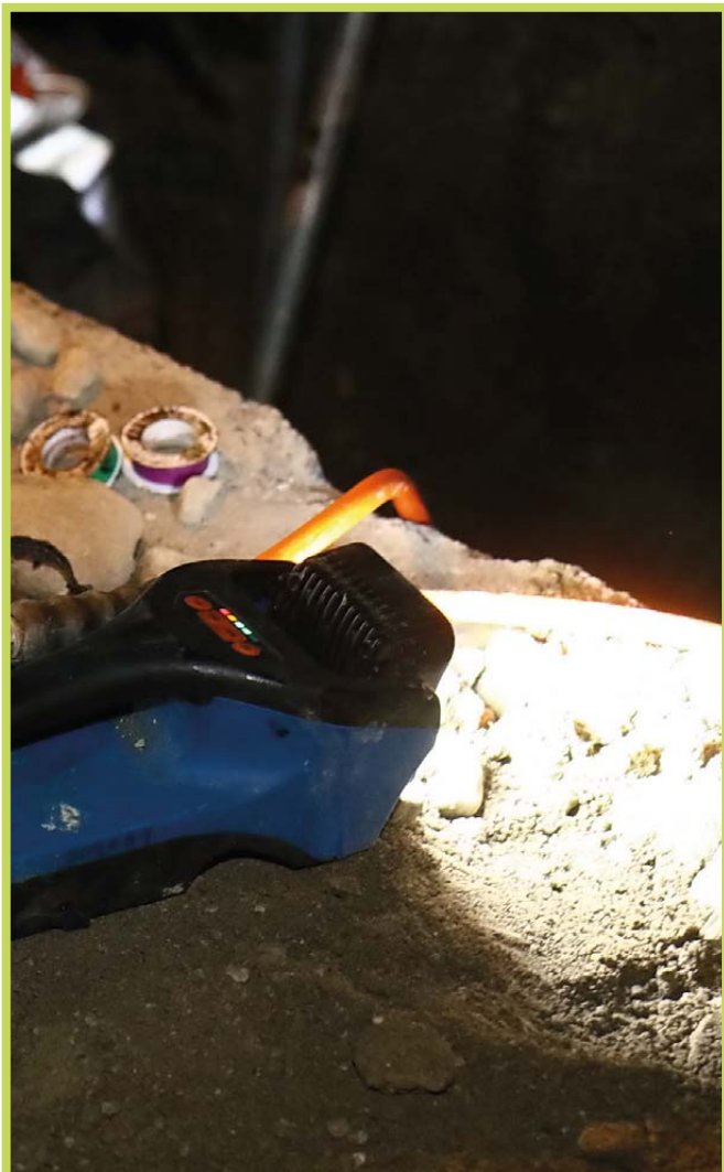
G50R- Výkyvná hlava svetidla a fluorescenčný povrch
