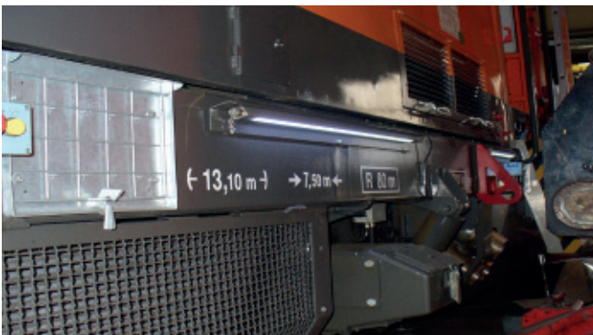
Osvetlenie krajnic a bezpečnostné osvetlenie zariadení na výstavbu koľajníc
