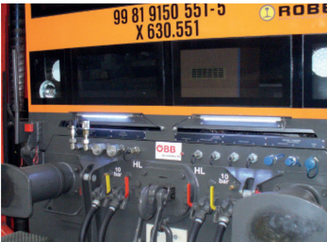
Osvetlenie krajnic a bezpečnostné osvetlenie zariadení na výstavbu koľajníc
