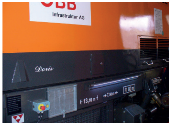
Osvetlenie krajnic a bezpečnostné osvetlenie zariadení na výstavbu koľajníc
