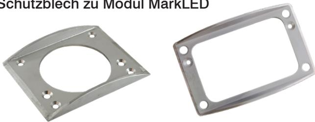
Häufig gibt es im Winter das Problem, dass die Schneepflüge beim Einfahren in, und Ausfahren aus den Tunnels, die Markierungsleuchten touchieren. Die Folgen sind abgescherte Einheiten und der Austausch derselben. Um dem abzuwehren, wurden Schutzbleche konstruiert. Diese schützen jeweils die ersten MarkLED beim Tunneleingang und -ausgang.
