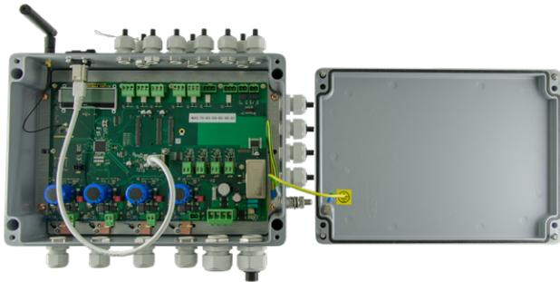
Die Steuereinheit für alle GIFAS-Systeme ist ausgelegt für 4 Abgangslinien. Jeder Kanal kann maximal mit 10A belastet werden.
