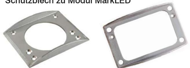
Häufig gibt es im Winter das Problem, dass die Schneepflüge beim Einfahren in, und Ausfahren aus den Tunnels, die Markierungsleuchten touchieren. Die Folgen sind abgescherte Einheiten und der Austausch derselben. Um dem abzuwehren, wurden Schutzbleche konstruiert. Diese schützen jeweils die ersten MarkLED beim Tunneleingang und -ausgang.
