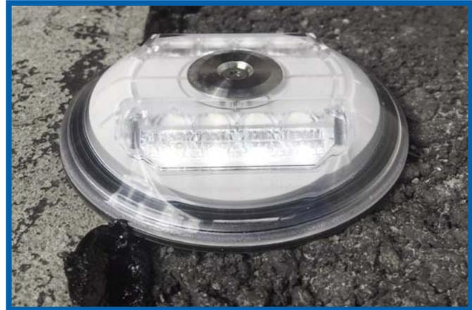
MarkLED ist ein kabelgeführtes System. Dadurch wird ein sehr hoher Wirkungsgrad (> 80%) erreicht, und das System bleibt damit unter den Grenzwerten für die elektromagnetische Verträglichkeit EMV. Mit der neuesten LED-Technologie ist die Stromaufnahme so gering, dass in der Regel die gewünschten Stranglängen ohne Zwischeneinspeisung realisiert werden können. Das System erfüllt die Vorschriften und Erwartungen der öffentlichen Anstalten und Ämter für das Straßenwesen auch international.
