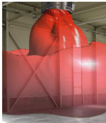
Untersuchung und Darstellung der GIFAS Turbulator Gesamtfunktion bei der Wärmerückführung in Hallen
