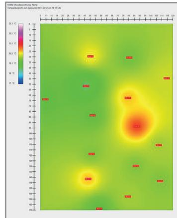
Die Heizsysteme sind in Betrieb aber es zeigen sich typische Kälte und Wärmeknoten mit ungleichmäßiger Temperaturverteilung.
