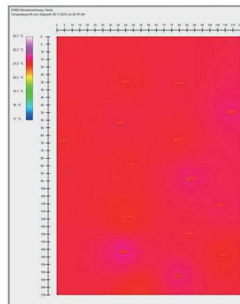
Innerhalb kürzester Zeit nach Zuschaltung der Turbulatoren ergibt sich ein homogenes Raumklima hinsichtlich Temperatur und Luftfeuchte in der Halle.
